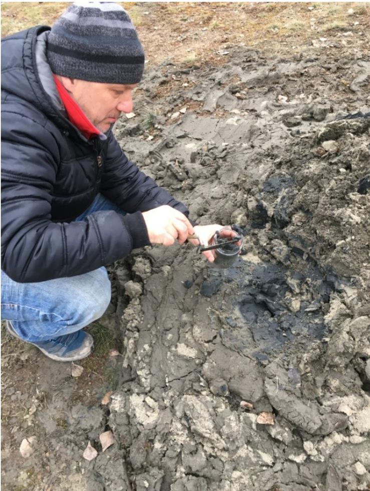
Schlammprobennahme nach zweiwöchiger Belüftungsphase
